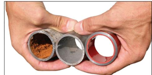
Verschmutztes, gereinigtes, beschichtetes Rohr.
